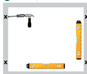
Deixe um vão para a instalação de sua esquadria. Meça com a trena a altura das Grapas de fixação e marque na alvenaria, abra um pequeno espaço. Verifique o esquadro, nível e o prumo do vão de instalação.
